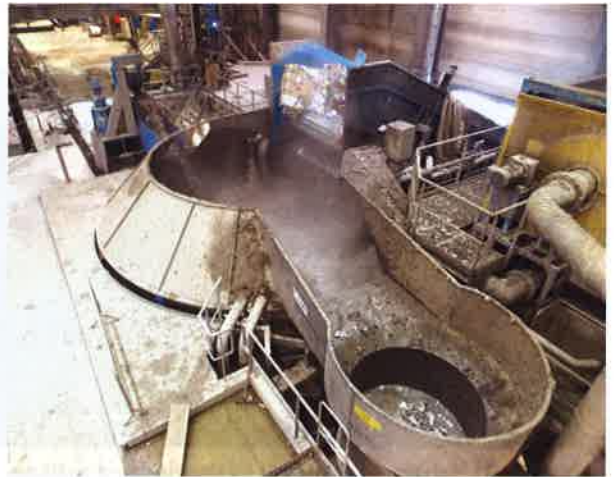
Fourni par Kadant, le nouvel atelier de préparation de pâte à base de fibres recyclées a remplacé les installations de pâte TMP.
