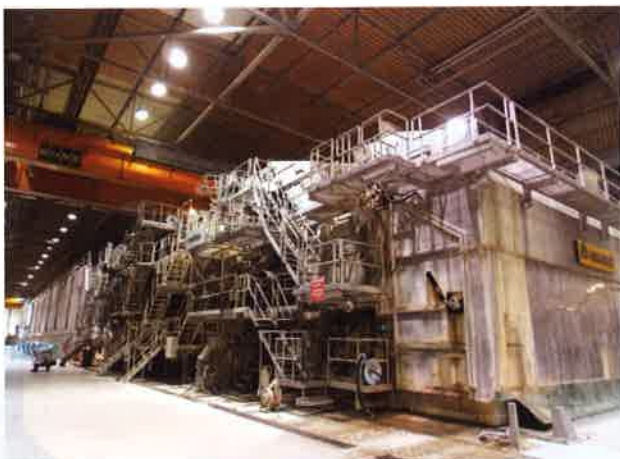
En partie humide, la géométrie et la formation de la feuille ont été repensées pour les adapter à une matière première uniquement à base de fibres recyclées et à la hausse du grammage.
