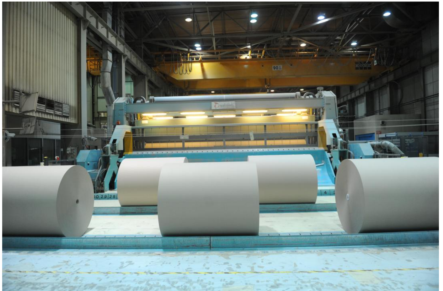
En sortie de production sur une laize (largeur) de 8,54 mètres, le papier refendu est enroulé pour l'expédition. PHOTOS DNA - JEAN-CHRISTOPHE DORN
